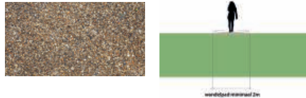
Wandelpaden van asphalt met een afstrooilaag van parelgrind.
